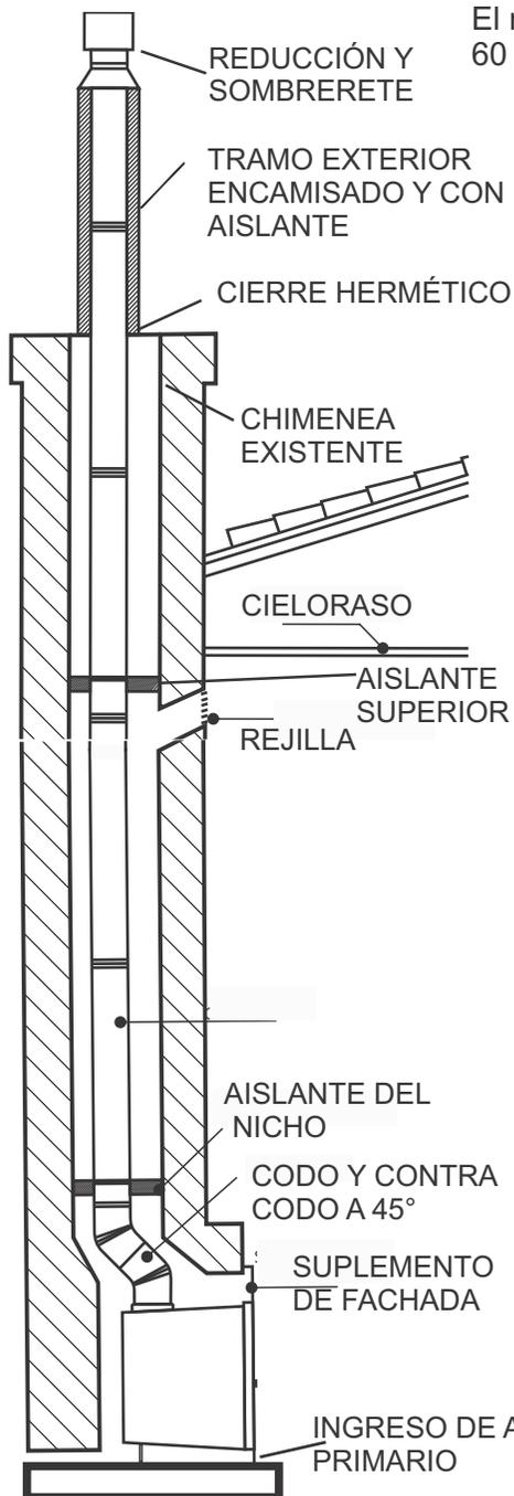
El remate exterior debe estar a los 4 vientos 60 cm. sobre el techo superior.
