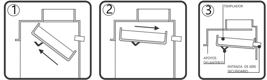
\_Ingresar el templador dentro de la caja de fuego de forma que la cara con orificios quede hacia abajo.
