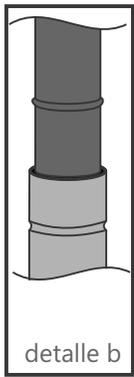
El caño superior se introduce dentro del caño inferior para evitar filtraciones de resina
