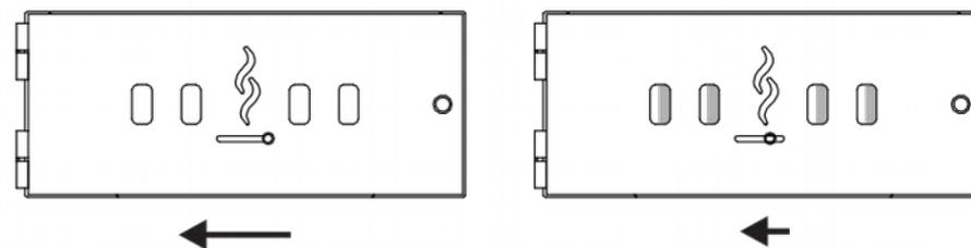
Al mover la palanca, usted hará que ingrese una mayor cantidad de aire a la caja de fuego de su horno. De esta manera puede lograr un encendido más rápido. Si quiere mantener la temperatura de cocción, cierre la misma; así logrará una temperatura constante.
